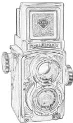
Die Rolleiflex ist eine berühmte Zweiaugenkamera. Sie ist von der Firma Franke & Heidecke (späterer Rolle) ab 1929 produziert worden. Die beiden übereinanderpositionierten Linsen bilden das charakteristische Erscheinungsbild.
